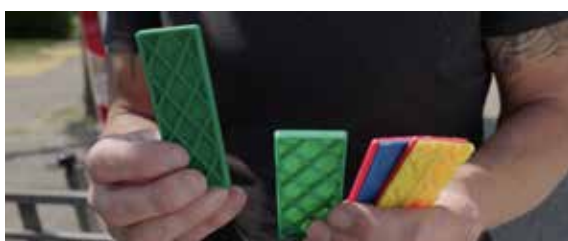
Gebruik in de basis groene glasblokjes, de andere kleuren gebruik je pas indien het nodig is om het glas op te klossen (zie
